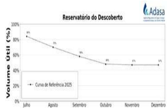
Figura 1 - Curva de referência para o acompanhamento do volume útil do reservatório do Descoberto no período de julho a dezembro de 2025
