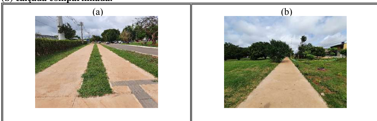
Figura 13 - Rotas Acessíveis Hospital Regional de Brazlândia - (a) e (b) Trechos com iluminação inexistente e sombreamento insatisfatório; (a) ciclovia em paralelo à calçada; (b) calçada compartilhada.
